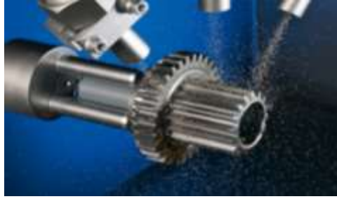
Şekil 2. Bir dişli çark üzerine uygulanan bilyalı dövme işlemi ("Bilyalı Dövme Fotoğrafı,")
