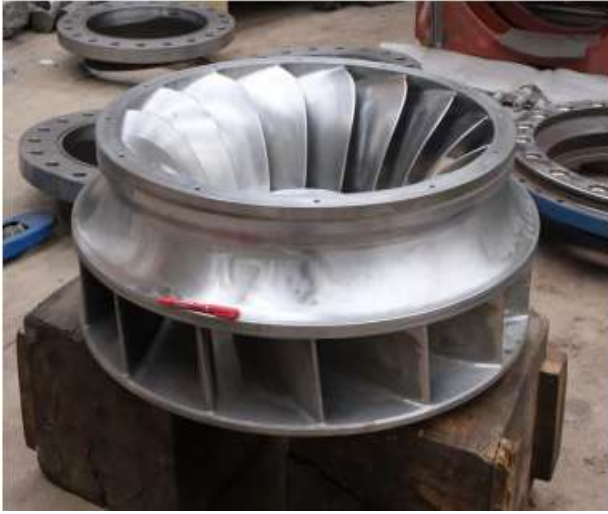
Şekil 6. Türbin Runner (solda). Runner kanatları (sağda) üzerinde suyun neden olduğu aşınma (ok ile gösterilen). (Ögel, 2022).
